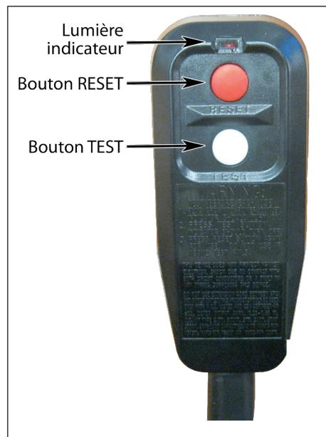
3. Appuyez sur le bouton RESET du disjoncteur GFCI. Le GFCI se réarmera et le spa se remettra en marche.
