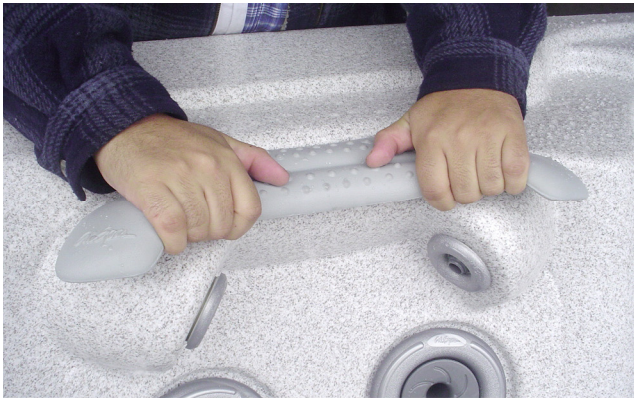
Figure 10. Démontage d'un coussin
