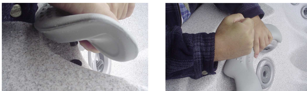
Figure 21. Remontage d'un coussin
