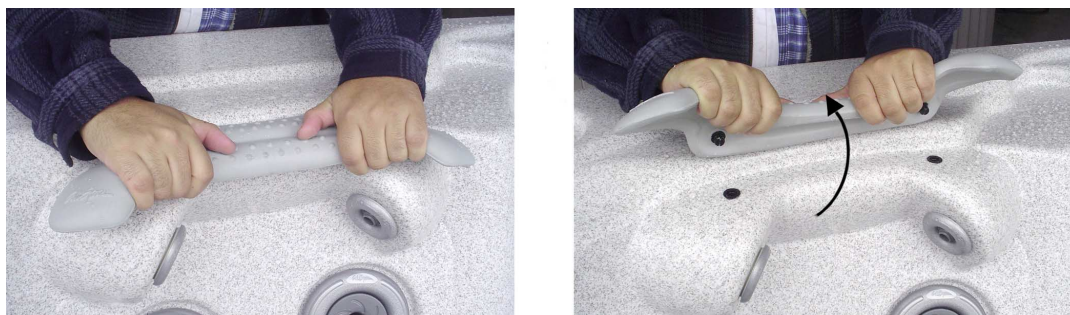
Figure 20. Démontage d'un coussin
